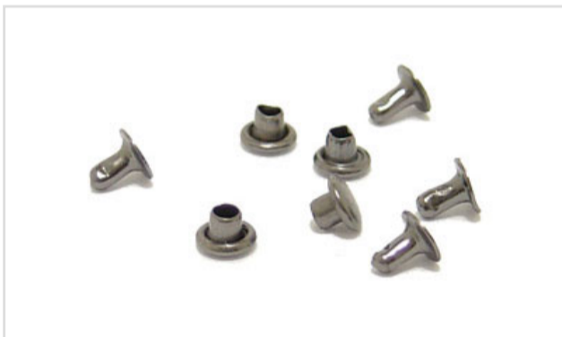
ANTRAG: Rebite 0,5 BESCHREIBUNG: Rivet 0.5 MATERIAL: Eisen oder Messing DIMENSIONEN: 4,5mm (kopf)
