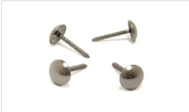
ANTRAG: 90x18 BESCHREIBUNG: Flat Head Tack Ref: 90X18 MATERIAL: Eisen DIMENSIONEN: 9mm (kopf) 18mm (höhe)
